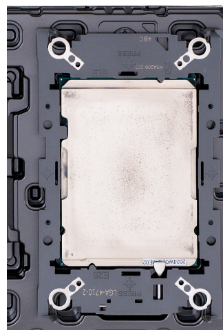
Рисунок 11 — Установка держателя процессора поверх процессора в упаковочной лотке
