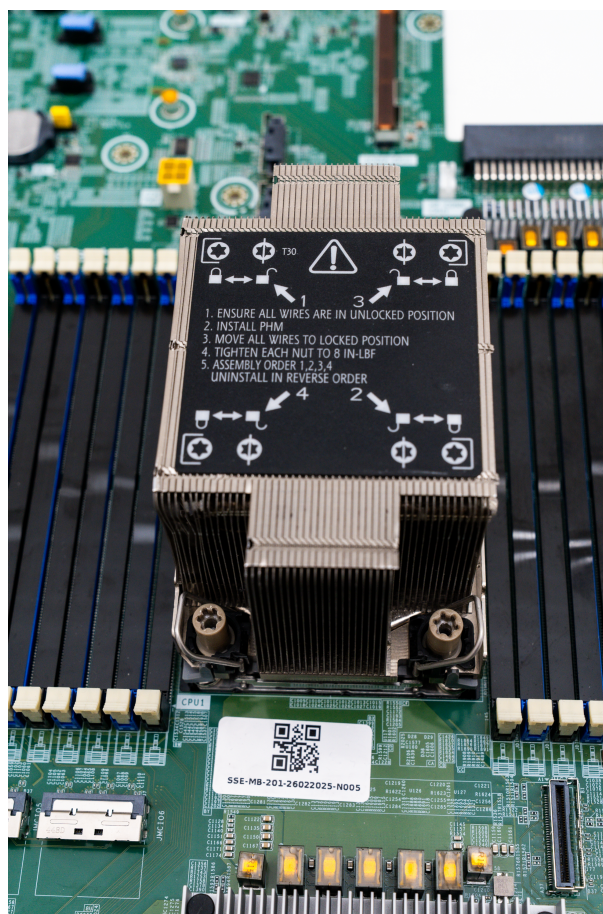
Рисунок 19 — Процессорный модуль на плате, фиксаторы в наружном положении
