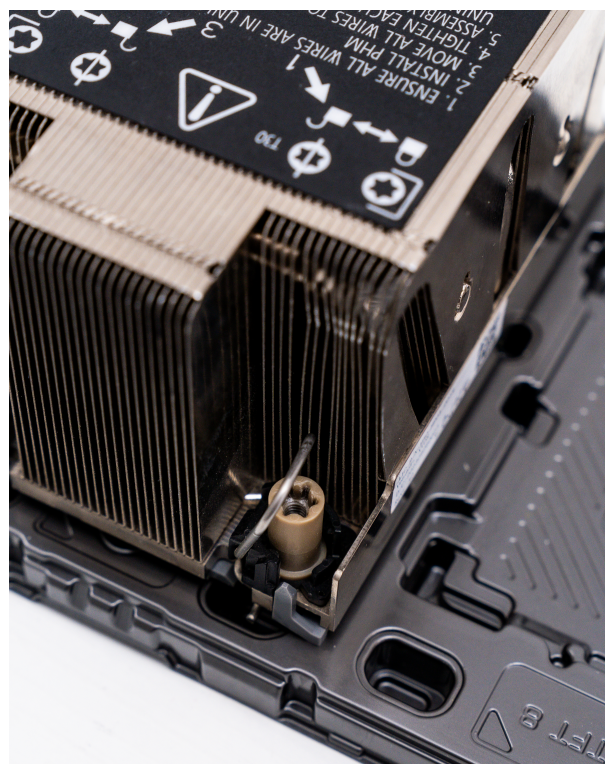
Рисунок 13 — Совмещение пина держателя и выреза на радиаторе
