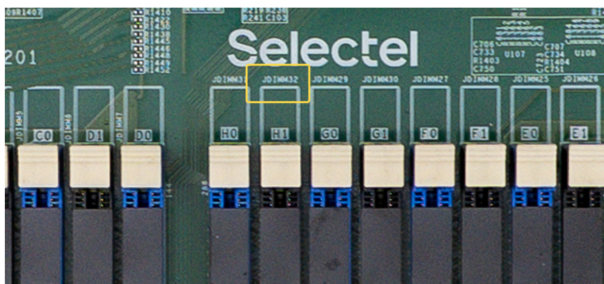
Рисунок 21 — Маркировка системной памяти на плате SSE-MB-201
