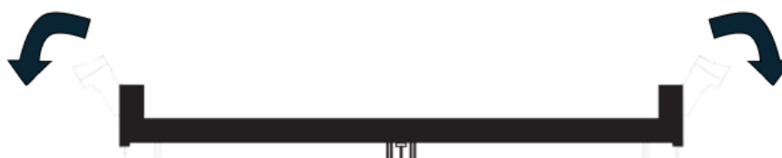
Рисунок 23 — Зажимы разъёма системной памяти на плате SSE-MB-201
