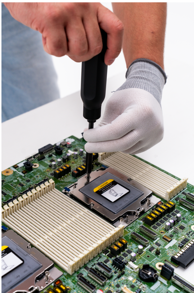
Рисунок 9 — Компоненты процессорного разъёма на материнской плате
